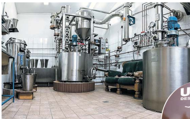
Srdcem palírny jsou dvě 150 litrové destilační linky, které umožňují individuální přístup ke každé zakázce.
